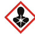
Pictogramme de danger associé à la présence de CMR 1, 2 ou 3 dans le produit, selon la nouvelle réglementation.
